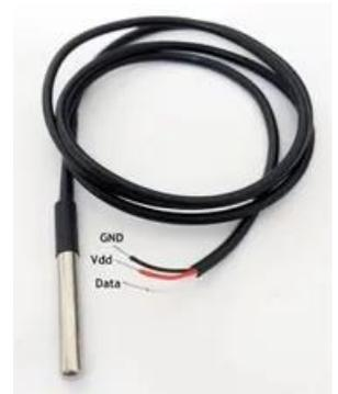
Ilustración 23: Sensor de temperatura DS18B20.
